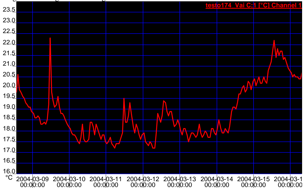
Figur 41 Loggning av lufttemperatur i betongstationen i Billeberga
